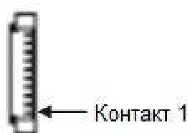
Рисунок 52. Ориентация штырькового 10-ти контактного разъема двухроторного вентилятора
