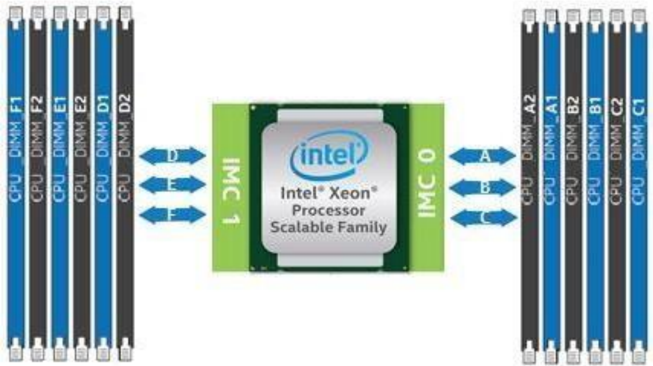
Рисунок 25. Каналы памяти процессора
