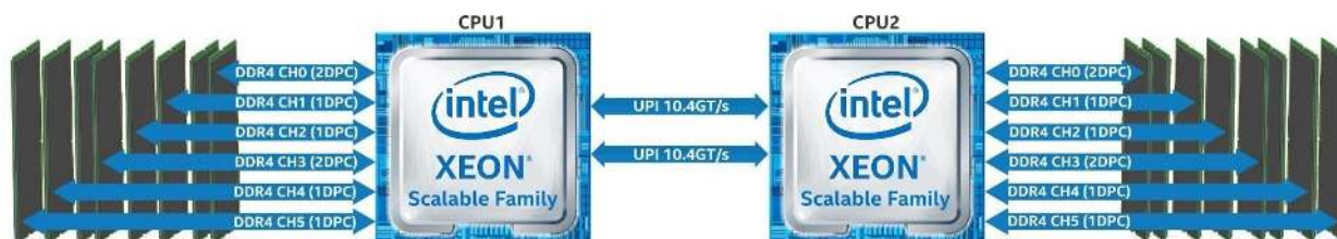
Рисунок 66. Архитектура подсистемы памяти
